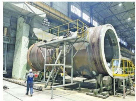
Кольцевой шов, соединяющий два полукорпуса реактора, выполнен методом автоматической сварки под слоем флюса в течение 10 суток. После сварки корпус пройдет термообработку, контроль и гидравлические испытания, которые подтвердят качество сварных соединений и уплотнительных поверхностей. Завершающим этапом изготовления корпуса
