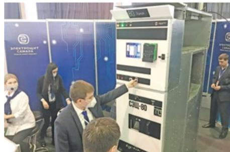
Ключевой разработкой Электроцит Самара, представленной на выставке, является комплектное распределительное устройство КРУ-СЭЩ-80 на 6(10) кВ, предназначенное для приема и распределения электрической энергии трехфазного переменного тока с частотой 50 Гц, номинальным значением напряжения 6(10) кВ и номинальным током до 2000 А. Цифровая ячейка КРУ-СЭЩ-80 соответствует требованиям МЭК и при этом по своим техническим параметрам полно-
