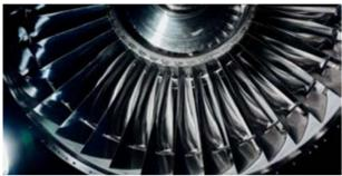
Газотурбинный двигатель Е70/8РД мощностью 8 МВт разработан рыбинским предприятием «ОДК-Сатурн» и может работать на двух видах топлива - газообразном (в том числе на попутном газе) и жидком (керосин или дизельное топливо). Его уникальной особенностью является возможность переключаться в автоматическом режиме и под нагрузкой с одного вида топлива на другой.
